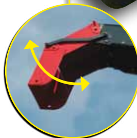
Ovládání směrové klapky komínu
