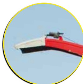
Ovládání směrové klapky komínu
