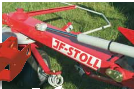
Stroje řady Pro mají velký pracovní záběr a robustní rám krabicového profilu.
