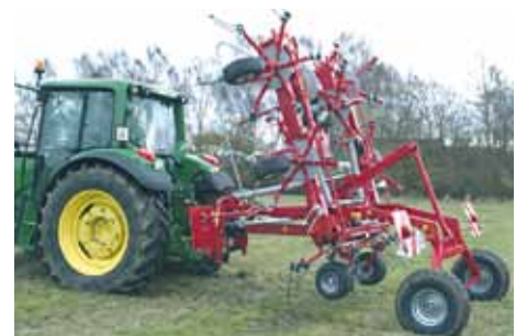
Z 905 Pro A má na rozdíl od neseného Z 905 D transportní podvozek – proto lze tento stroj agregovat i s menšími traktory.
