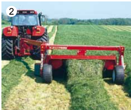
2 Žací stroje JF-STOLL mají pracovní záběr od 1,7 m do 12 m. Mohou posečenou hmotu rozhazovat na široko nebo ukládat na jednoduchý nebo dvojitý řádek.
