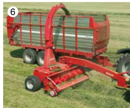
6 Návěsné řezačky JF-STOLL lze dodat se sběračem širokým 1,6 ÷ 3,1 m, žací lištou a kukuřičným adaptérem.
