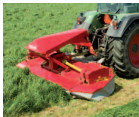
Žací stroj GXF lze použít i vzadu na traktoru při jízdě na zpátečku.
